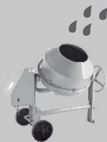
Adicionar parte da água até a argamassa atingir o ponto de argamassa firme.
