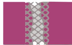
5 - Em trincas com aberturas de aproximadamente 2mm, aplicar uma tela de fibra de vidro com 5cm de largura sobre a extensão da trinca ou junta de dilatação sobre a primeira demão do Aditive Trincas & Fissuras ainda fresco para que a mesma cole sobre o produto. Após secagem, aplicar mais uma demão de Aditive Trincas & Fissuras cobrindo toda a tela de fibra de vidro, dando acabamento fino.
