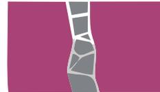
6 - Em trincas profundas, usar um limitador de profundidade do tipo isopor ou espuma.
