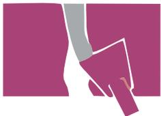
4 - Aplicar o Aditive Trincas & Fissuras preenchendo todo o vão da fissura, transpassando as bordas da mesma em 2,5cm para ambos os lados.
