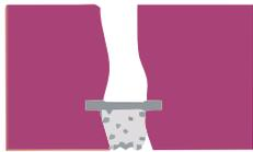
1 - Abrir levemente a trinca / fissura, limpando-a bem para retirar a poeira resultante e detritos.
